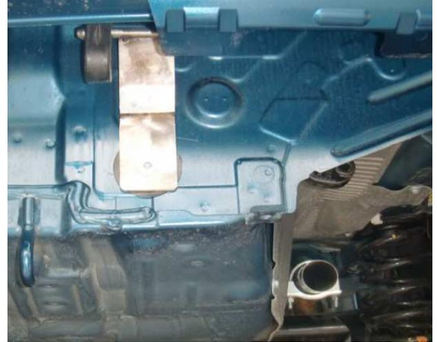
Den REMUS Sportschalldämpfer auf das Verbindungsrohr aufschieben und die Gummiaufhängungen an den Befestigungspunkten der Karosserie einhängen. (Abb.9)
