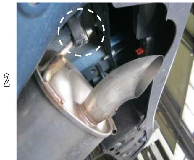
Den serienmäßigen Vorschalldämpfer mit geeigneten Hilfsmitteln abstützen. Flanschverbindung des Vorschalldämpfers lösen. (Abb.3)
